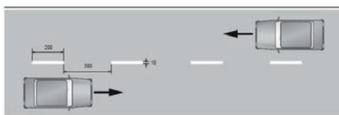
LÍNEAS DE EJE CENTRAL SEGMENTADA
